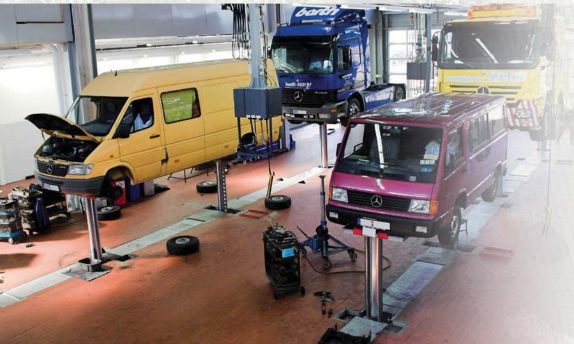
Dwa podnośniki 4-słupowe HVV używane jako podnośniki 2-słupowe.
