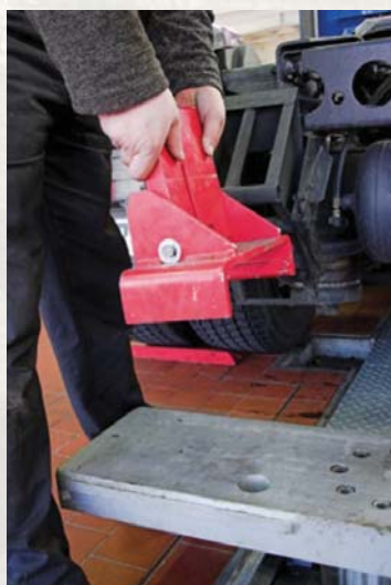
System wymiennych uchwytów umożliwia podnoszenie różnego typu pojazdów.
