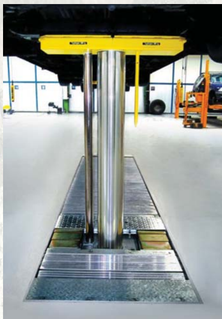
Słup teleskopowy z opcjonalną podporą zabezpieczającą (zgodnie z EN 1493:2010).
