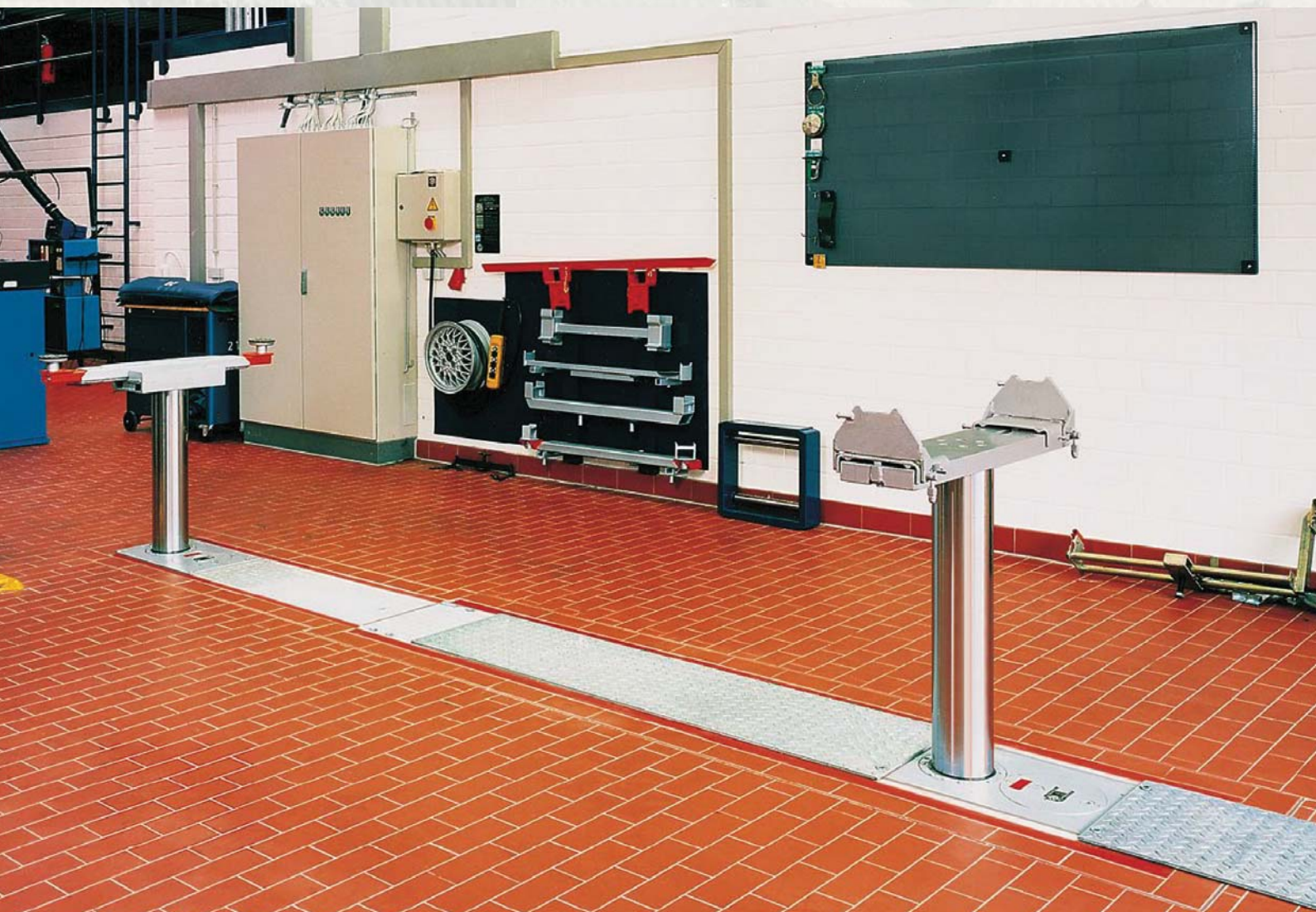
Na zdjęciu podnośnik 2-słupowy o udźwigu 8.000 kg na kolumnę.
